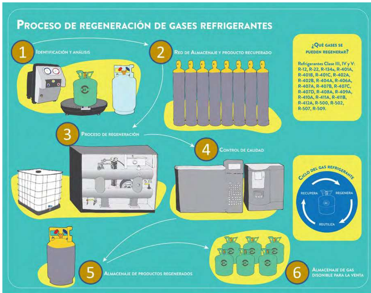
Imagen 8 Ciclo del refrigerante en un centro de regeneración
