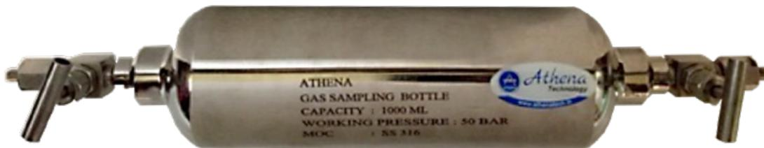
Las válvulas, fitting, conexiones y ajuga para burbujear refrigerante deben ser de acero inoxidable.
